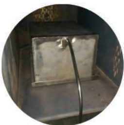
باکس اتمسفر کنترل
